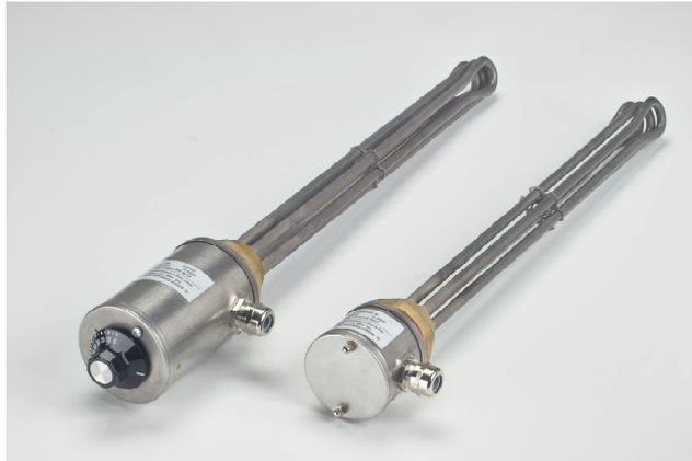
Drei u-förmig gebogene Rohrheizkörper sind in der Standardausführung in einen Schraubkopf G 1 ½" hart eingelötet. Die unbeheizte Zone ist 30 mm lang. Der jeweilige Werkstoff für Rohrmantel und Schraubkopf richtet sich nach der zu erwärmenden Flüssigkeit und der gewünschten Temperatur (siehe Bedienungsgrundlagen).
