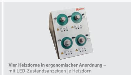
Vier Heizdorne in ergonomischer Anordnung – mit LED-Zustandsanzeigen je Heizdorn
