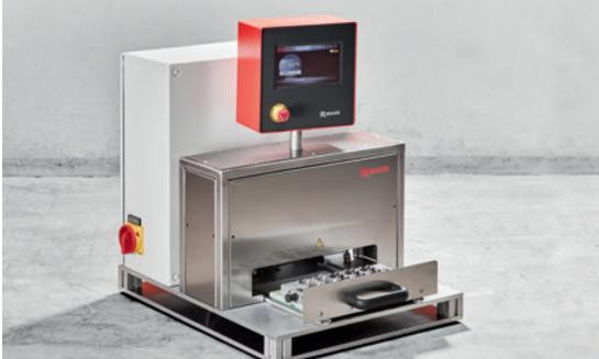
**Infrarot-Heizsystem** – für ein energieeffizientes und schnelles Schrumpfen von Schläuchen an Bauteilen.
